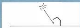
En été, le soleil, presque à la verticale ne peut pénétrer dans la maison
